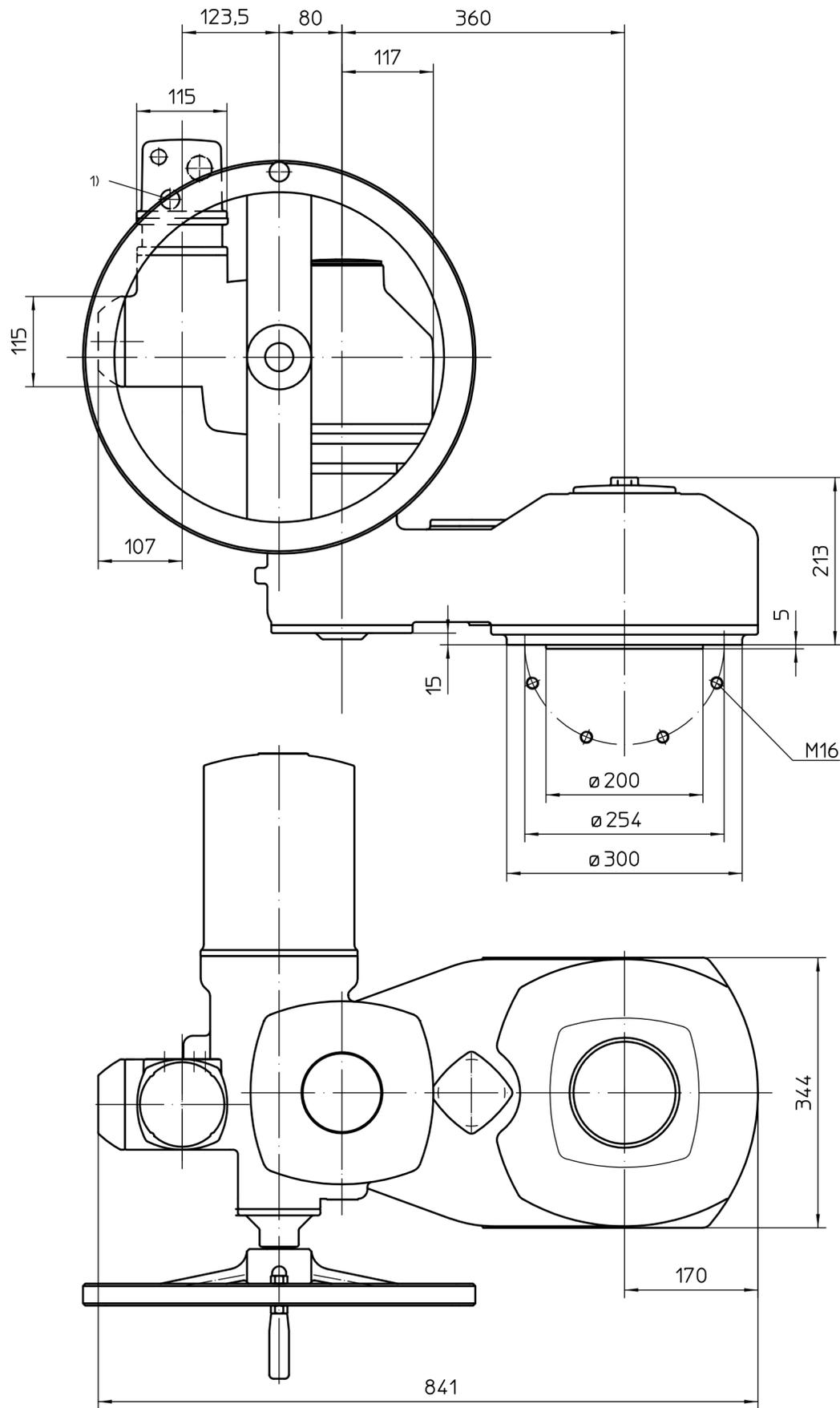
M16 Bord inférieur GST = Arbre de sortie B.C.E
